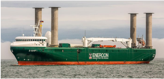
E-Ship 1 ist ein Flettner-Schiff: Vom Deck des Schiffs ragen vier große Rotorsegel empor, die durch eine mechanische Verbindung mit den Schiffsschrauben in Drehung versetzt werden. Alan Jamieson aus Aberdeen, Schottland, CC BY 2.0 < https://creativecommons.org/licenses/by/2.0/ >, über Wikimedia Commons
