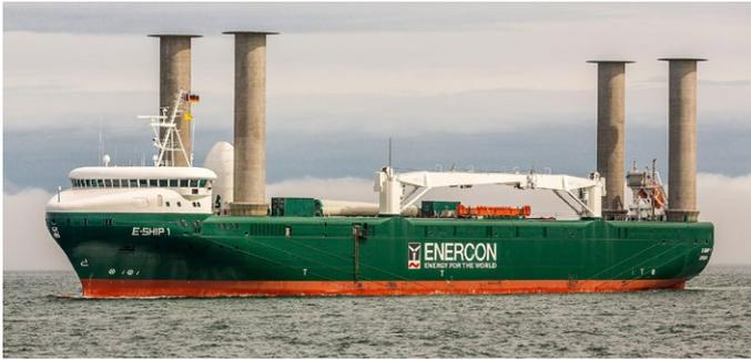
El E-Ship 1 es un buque Flettner: cuatro grandes velas de rotor que se elevan desde la cubierta y giran a través de una conexión mecánica con las hélices del barco. Alan Jamieson de Aberdeen, Escocia, CC BY 2.0 <<https://creativecommons.org/licenses/by/2.0/>>, mediante Wikimedia Commons
