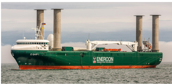
El E-Ship 1 es un buque Flettner: cuatro grandes velas de rotor que se elevan desde la cubierta y giran a través de una conexión mecánica con las hélices del barco. Alan Jamieson de Aberdeen, Escocia, CC BY 2.0 < https://creativecommons.org/licenses/by/2.0/ >, mediante Wikimedia Commons
